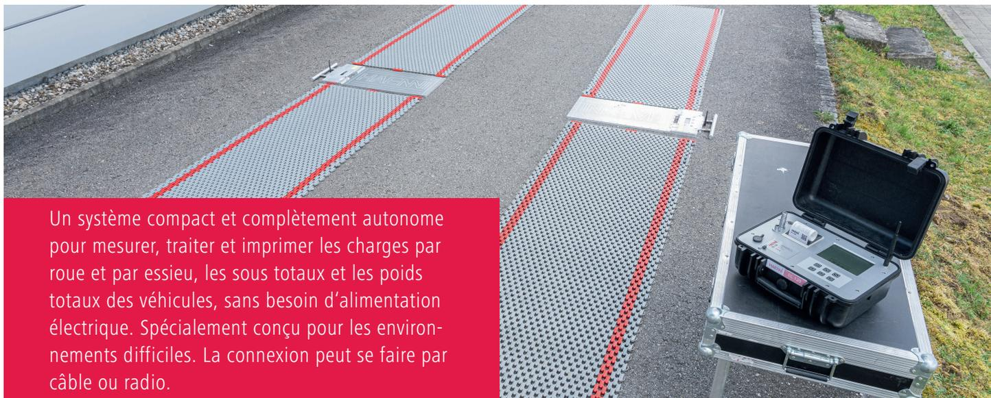
Un système compact et complètement autonome pour mesurer, traiter et imprimer les charges par roue et par essieu, les sous totaux et les poids totaux des véhicules, sans besoin d'alimentation électrique. Spécialement conçu pour les environnements difficiles. La connexion peut se faire par câble ou radio.
