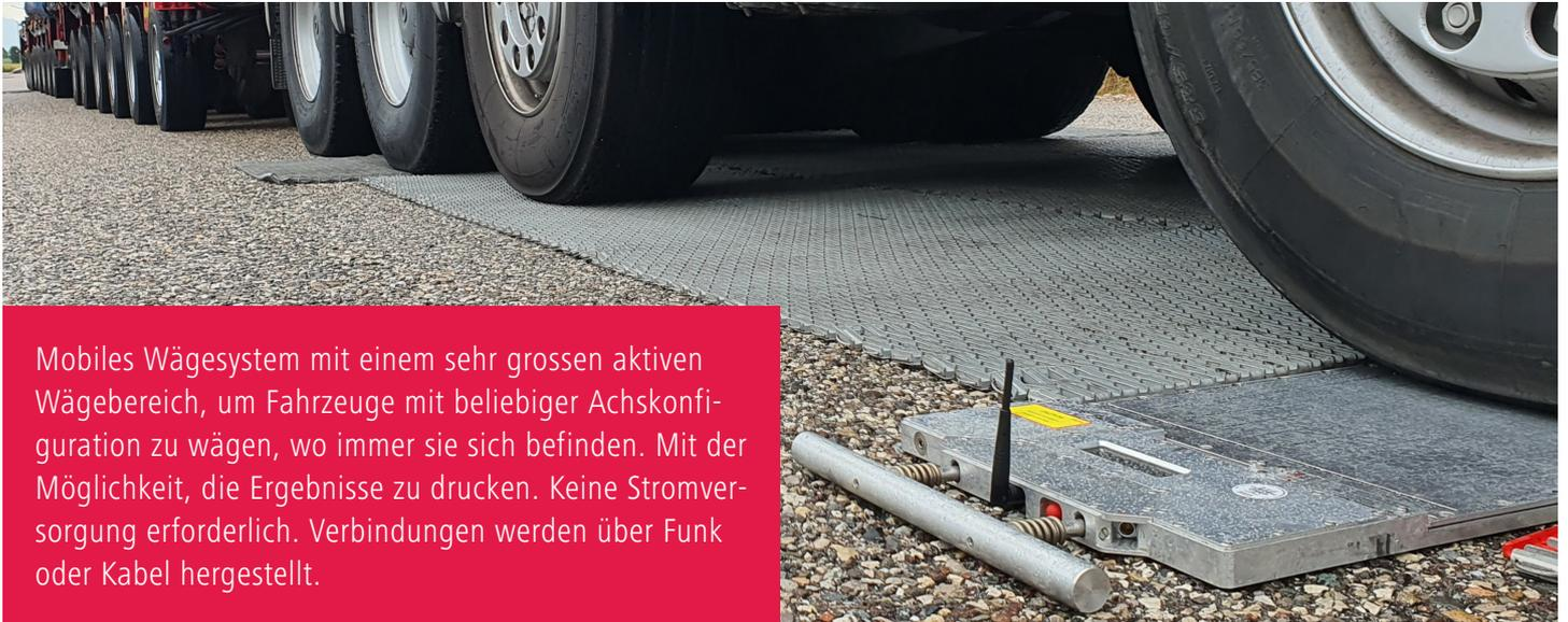
Mobiles Wägesystem mit einem sehr grossen aktiven Wägebereich, um Fahrzeuge mit beliebiger Achskonfiguration zu wägen, wo immer sie sich befinden. Mit der Möglichkeit, die Ergebnisse zu drucken. Keine Stromversorgung erforderlich. Verbindungen werden über Funk oder Kabel hergestellt.
