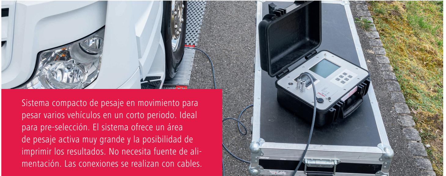
Sistema compacto de pesaje en movimiento para pesar varios vehículos en un corto periodo. Ideal para pre-selección. El sistema ofrece un área de pesaje activa muy grande y la posibilidad de imprimir los resultados. No necesita fuente de alimentación. Las conexiones se realizan con cables.
