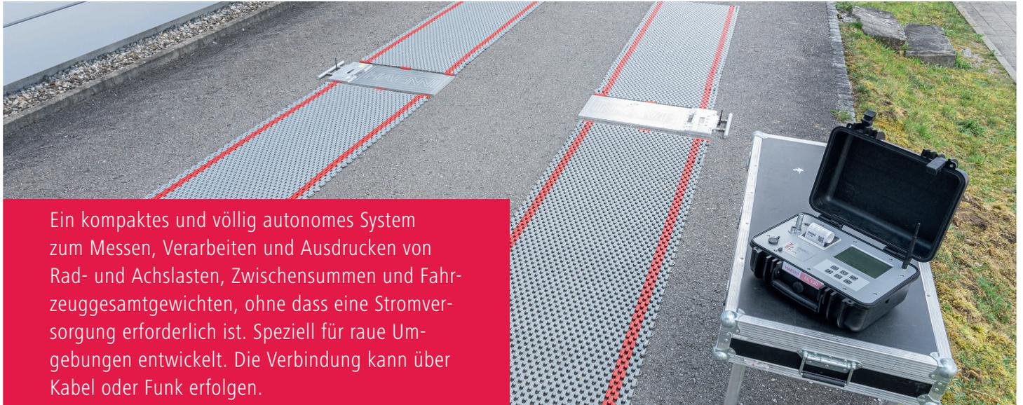
Ein kompaktes und völlig autonomes System zum Messen, Verarbeiten und Ausdrucken von Rad- und Achslasten, Zwischensummen und Fahrzeugesamtwichten, ohne dass eine Stromversorgung erforderlich ist. Speziell für raue Umgebungen entwickelt. Die Verbindung kann über Kabel oder Funk erfolgen.
