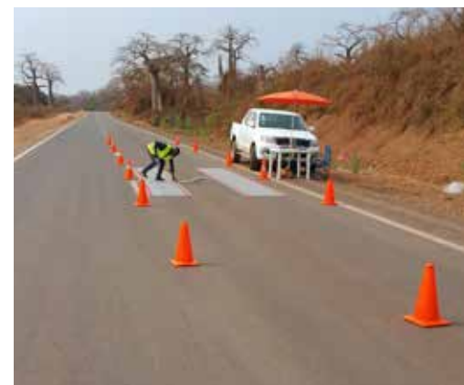
Pré-seleção realizada com sistema WIM de baixa-ve- locidade na Angola
