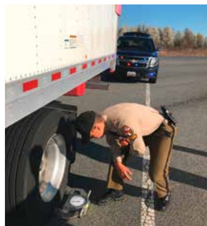
A balança mecânica WL 101 é amplamente utilizada nos EUA para o controle de peso oficial
