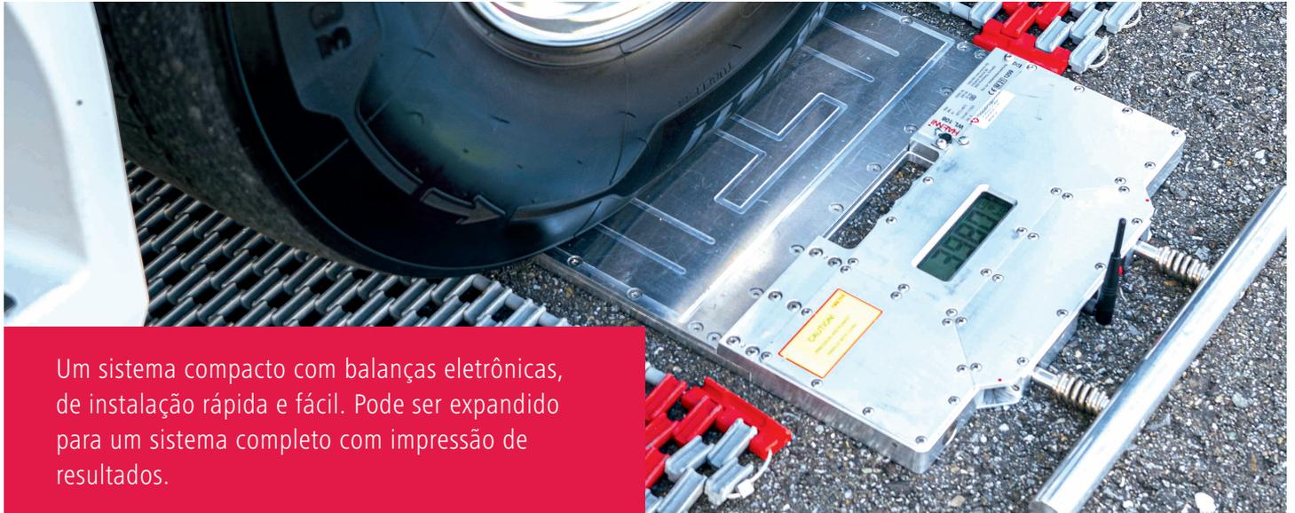
Um sistema compacto com balanças eletrônicas, de instalação rápida e fácil. Pode ser expandido para um sistema completo com impressão de resultados.
