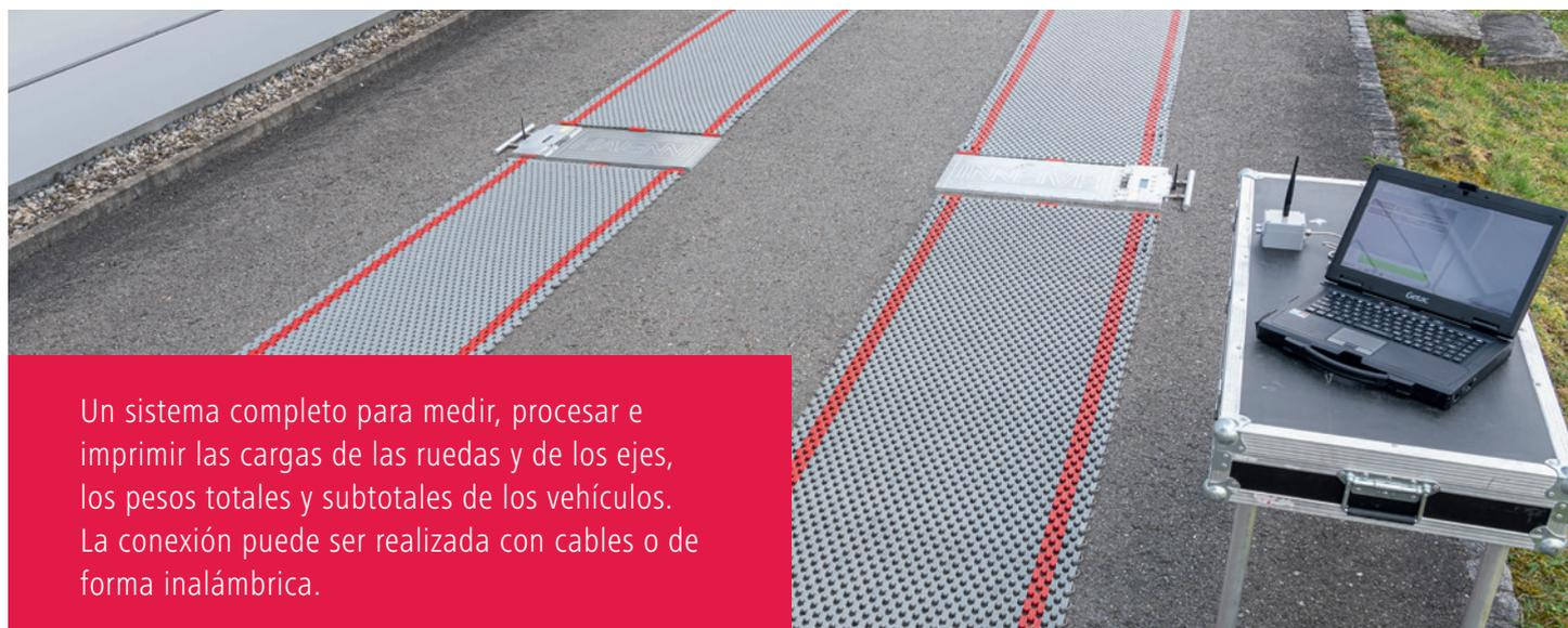
Un sistema completo para medir, procesar e imprimir las cargas de las ruedas y de los ejes, los pesos totales y subtotales de los vehículos. La conexión puede ser realizada con cables o de forma inalámbrica.
