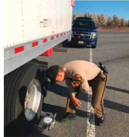
Die mechanische Waage WL 101 wird in den USA weit verbreitet für die offizielle Gewichtskontrolle eingesetzt
