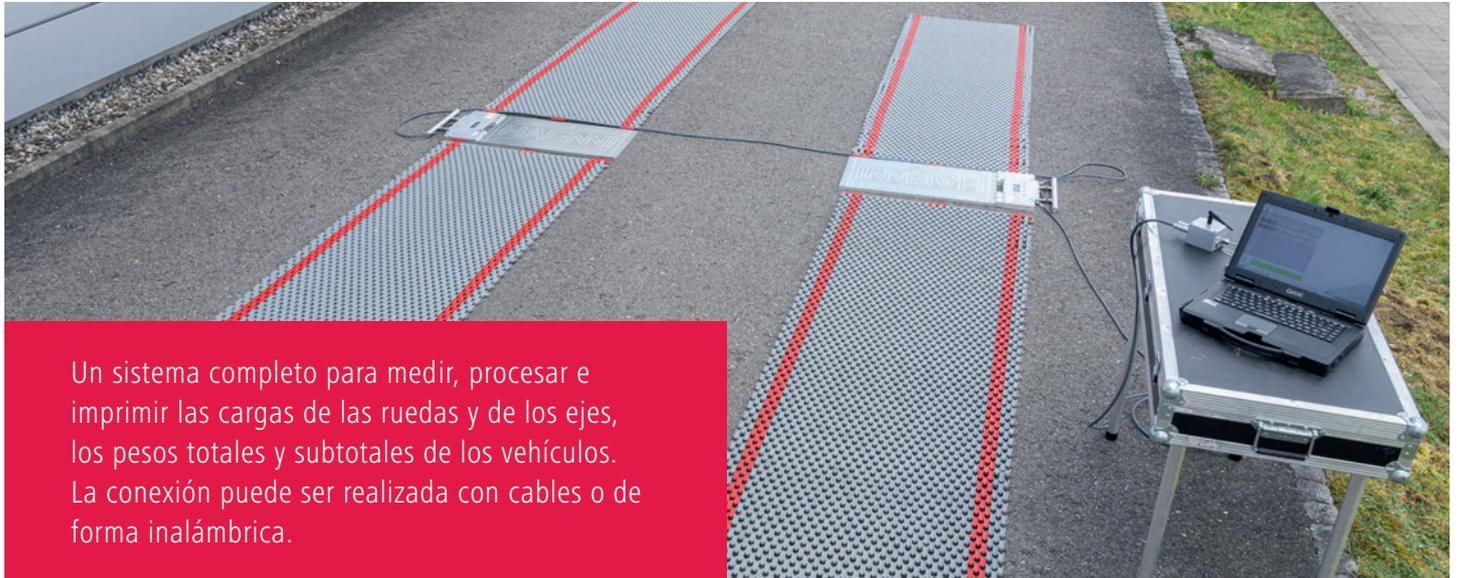
Un sistema completo para medir, procesar e imprimir las cargas de las ruedas y de los ejes, los pesos totales y subtotales de los vehículos. La conexión puede ser realizada con cables o de forma inalámbrica.
