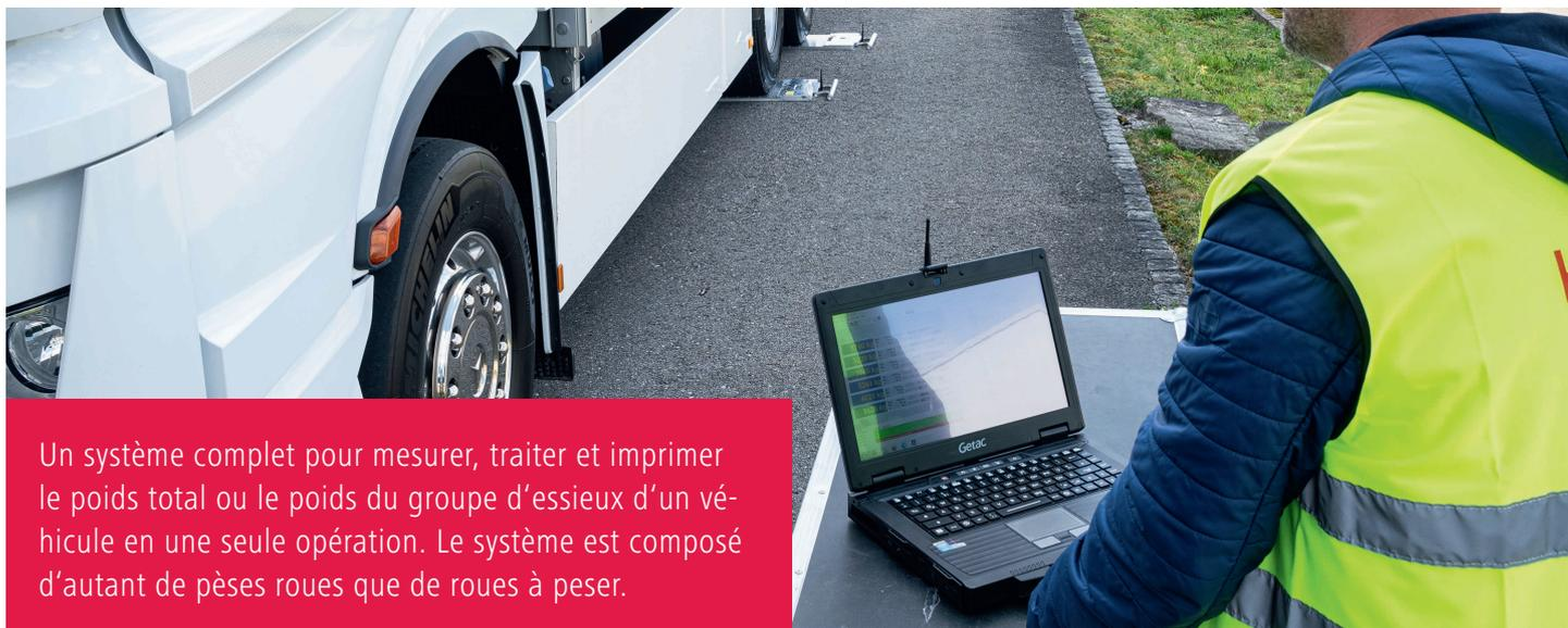
Un systeme complet pour mesurer, traiter et imprimer le poids total ou le poids du groupe d'essieux d'un vehicule en une seule operation. Le systeme est compose d'autant de peses roues que de roues a peser.
