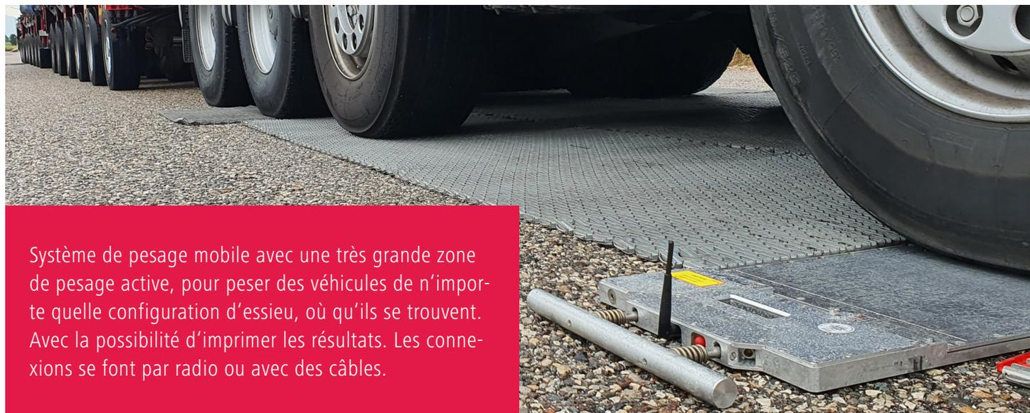
Système de pesage mobile avec une très grande zone de pesage active, pour peser des véhicules de n'importe quelle configuration d'essieu, où qu'ils se trouvent. Avec la possibilité d'imprimer les résultats. Les connexions se font par radio ou avec des câbles.
