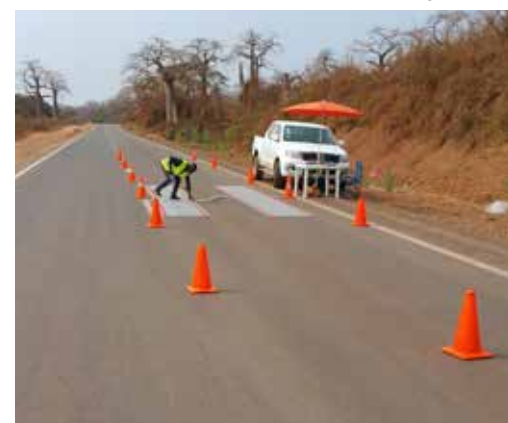
La preselección se lleva a cabo con sistema WIM de baja velocidad en Angola
