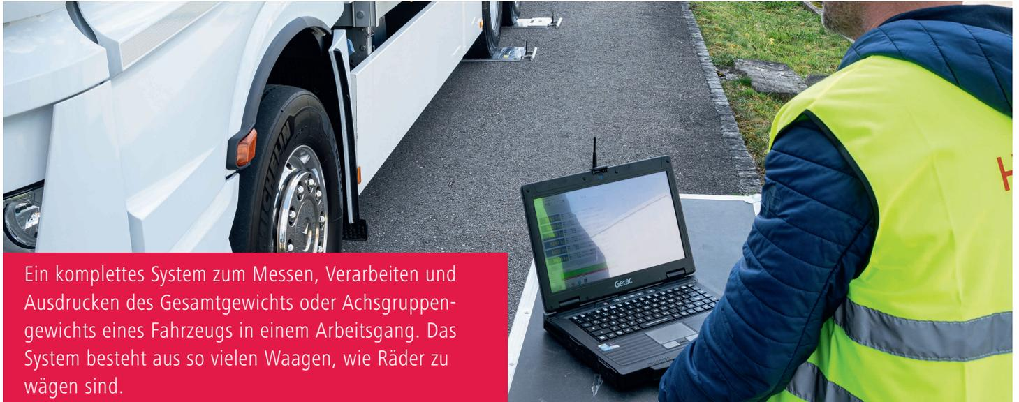
Ein komplettes System zum Messen, Verarbeiten und Ausdrucken des Gesamtgewichts oder Achsgruppen-gewichts eines Fahrzeugs in einem Arbeitsgang. Das System besteht aus so vielen Waagen, wie Räder zu wägen sind.
