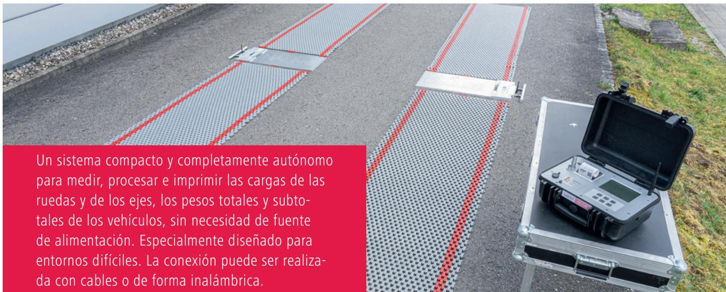
Un sistema compacto y completamente autónomo para medir, procesar e imprimir las cargas de las ruedas y de los ejes, los pesos totales y subtotales de los vehículos, sin necesidad de fuente de alimentación. Especialmente diseñado para entornos difíciles. La conexión puede ser realizada con cables o de forma inalámbrica.
